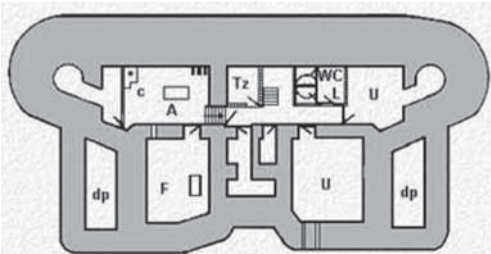
Schéma dolného, tylového poschodia zrubu N-S 71 - A - diesलगregát, F - filtrovňa, U - ubikácie, Tz - zemná telegrafia, L - umyváreň, c - čerpadlo, dp - diamantová-ochranná priekopa.
